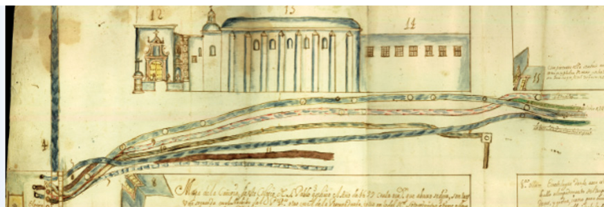
Figura 3. Caja de agua y cañería del Colegio Máximo de San Pablo. 30
