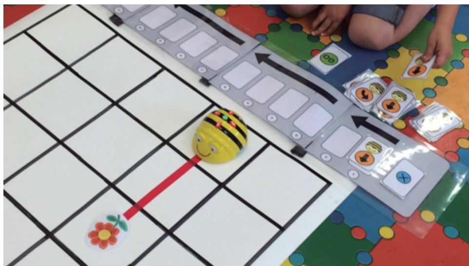
Figura 4. Ejemplo de uso del lenguaje simbólico de las tarjetas de instrucciones y de la caja de secuenciación en una tarea con el robot Bee-bot
