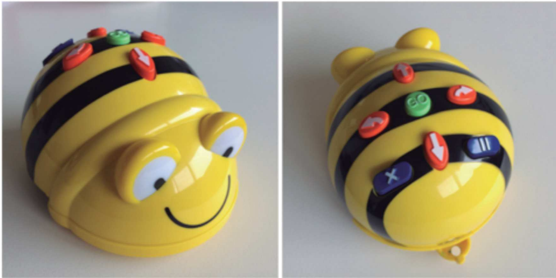
Figura 1. El robot Bee-bot y sus botones de programación
