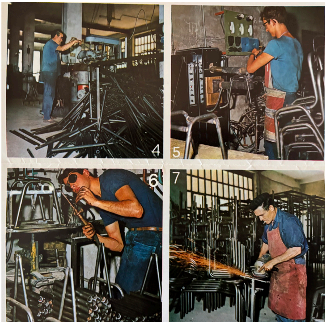
Fig. 8. Fotografía obtenida de catálogo comercial, del trabajo de soldadura de las estructuras de los muebles, de finales de los años 60. Fuente: Archivo Pepe Escrihuela.
