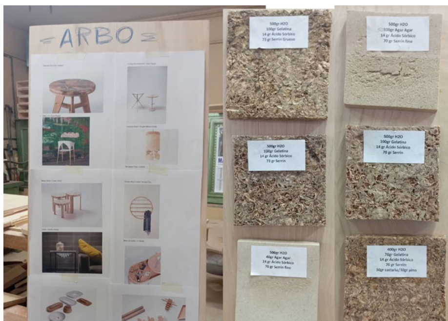
Fig. 5. Fotografías del taller durante el proceso de diseño y experimentación con distintos materiales, siendo aquellos con viruta de madera más fina los que contaban con un mejor comportamiento durante el secado, al combarse y deformarse menos.
