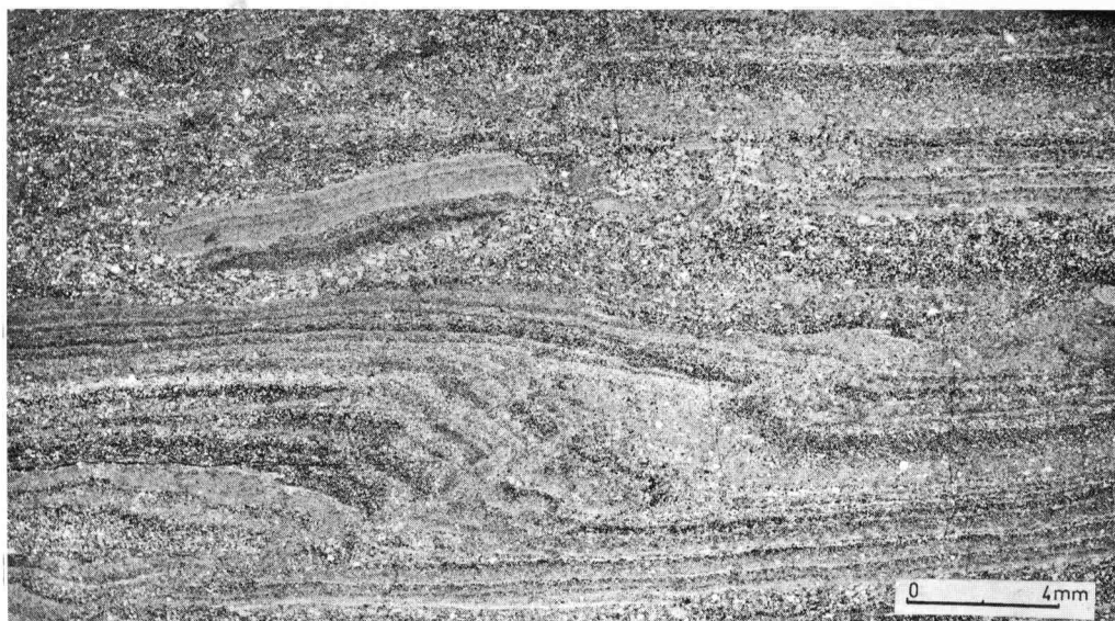
Laminaciones y «slumpings» de una pelmicrita en el nivel dolomítico (muestra C-24, fig. 3; negativo)
