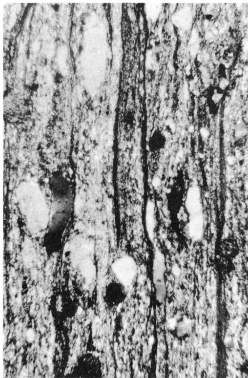
Fig. 7.—Esquistosidad de primera fase ( S_1 ) del tipo «slaty cleavage» grueso, desarrollado en materiales microconglomeráticos (N.P. \times 10 ).
