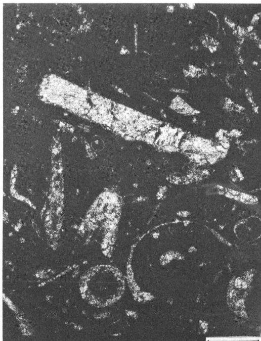
Fig. 7.—Wackestone de moluscos. Hay bivalvos, gasterópodos y dasicladaceas embebidos en una matriz micrítica.
