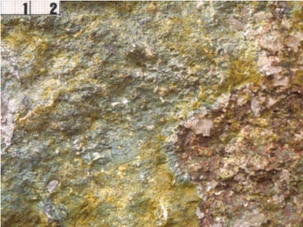
Figura 6. Aspecto macroscópico de la Caliza Griotte variedad verde con acabado natural. Escala: 2 cm.
