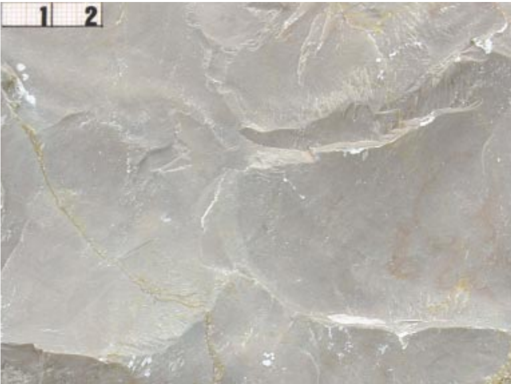
Figura 7. Aspecto macroscópico de la Caliza Griotte variedad gris con acabado escafilado. Escala: 2 cm.
