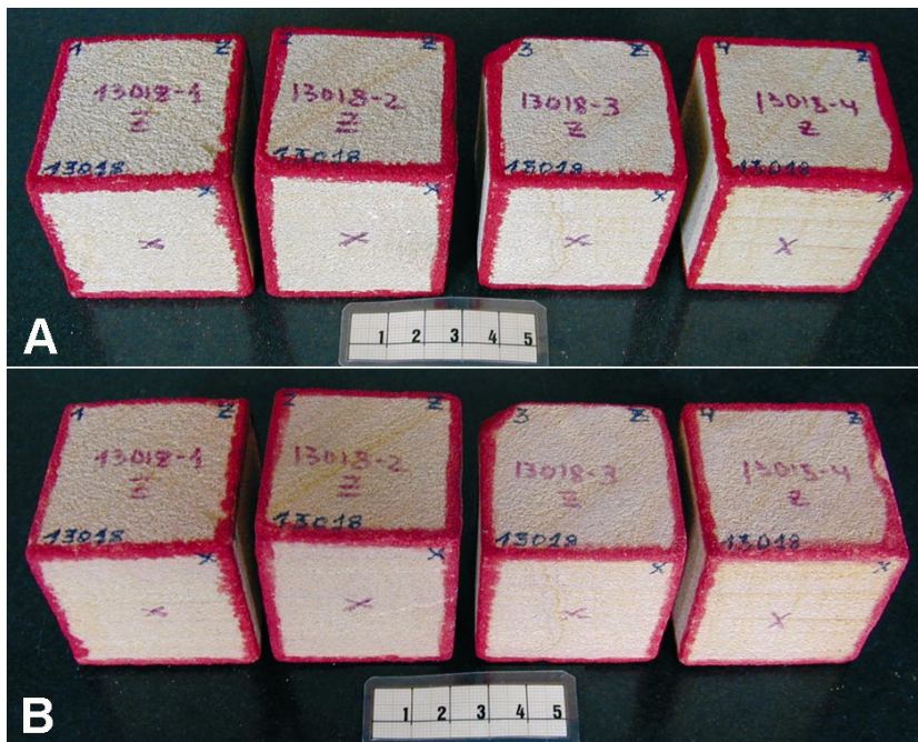
Figura 5. Probetas de la variedad amarilla de la Arenisca de La Marina antes (A) y después (B) de los ciclos de hielo-deshielo. Escala en cm.
