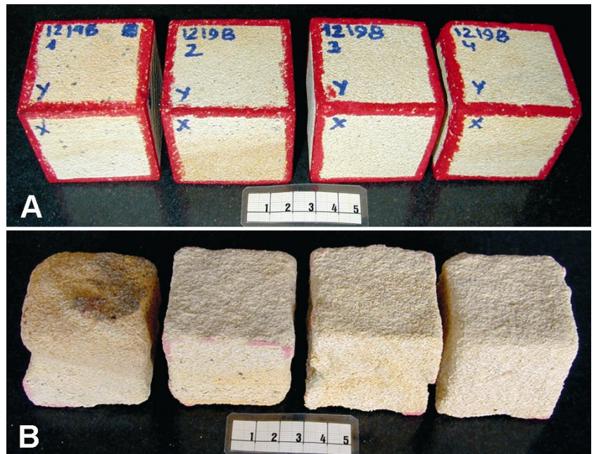
Figura 7. Aspecto de las probetas de arenisca amarilla antes (A) y después (B) del ensayo de cristalización de sales. Escala en cm.
