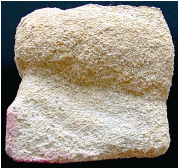
Figura 10. Aspecto de una probeta de arenisca amarilla sometida al ensayo de cristalización de sales en la que se manifiesta una alteración diferencial condicionada por la composición mineralógica y la textura. Arista: 5 cm.
