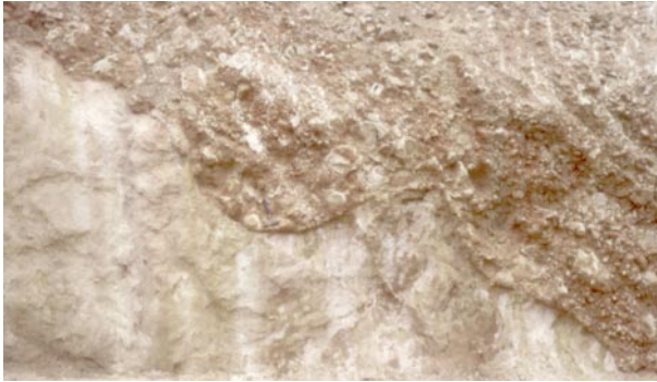
Figura 2. Contacto discordante de materiales paleógenos sobre arenas de la parte baja de la Formación La Ería. Talud de la incorporación de la ronda de circunvalación de Infiesto a la carretera N-634. La longitud del martillo en el centro de la foto es de unos 40 cm.
