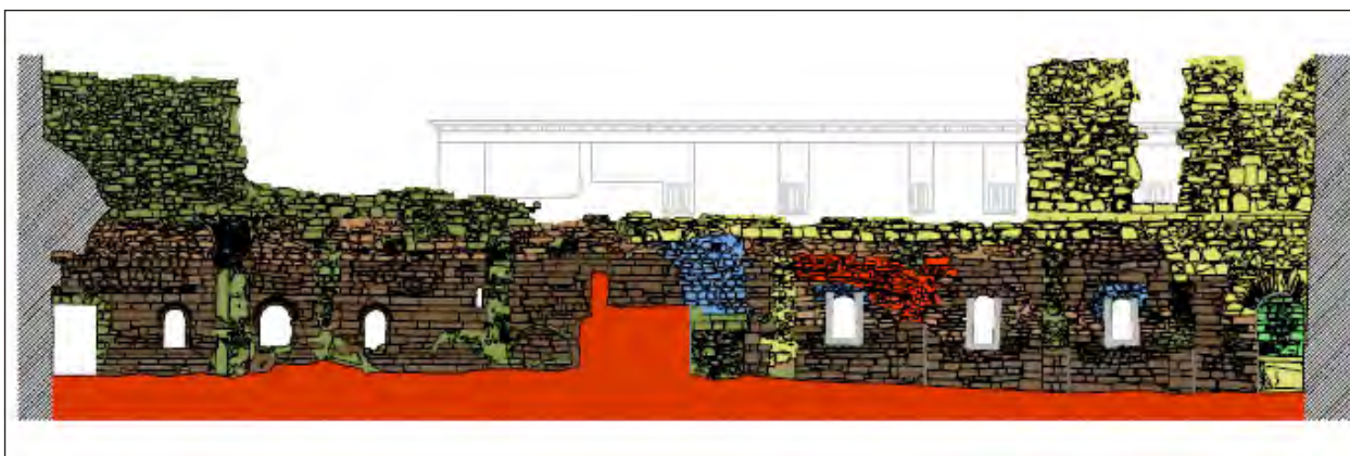
Figura 1.- La lectura de paramentos permite identificar el complejo proceso constructivo de la mayoría de los edificios. Muro exterior del pabellón de monjes del Monasterio de Santa María de Moreruela (Zamora), según F. Miguel y L. Pichel, en Miguel, 2008.
