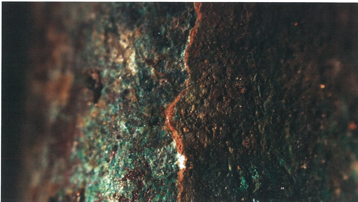
Sustrato de corrosión bajo la pátina. 140x
