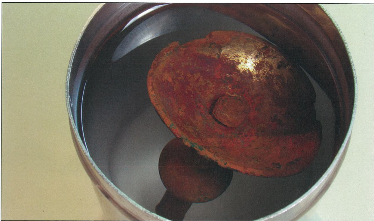
Proceso de pasivación por inmersión en caliente. El proceso neutraliza la alteración de la pieza
