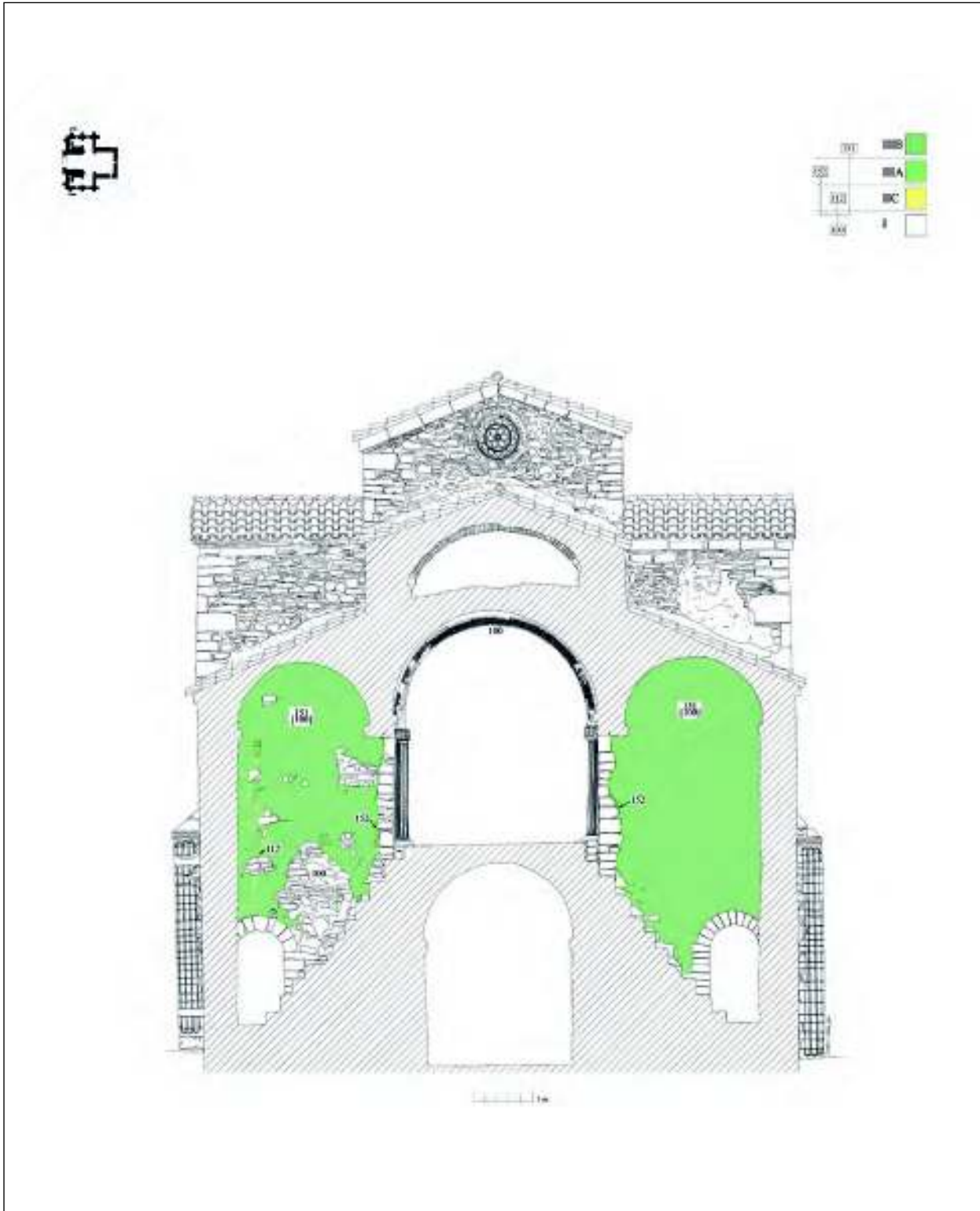
Pl. II.- Sección transversal por las escaleras a este. E. 1/100 (sobre planimetría de Lorenzo Arias).
